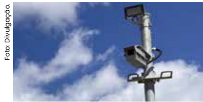
Além da fiscalização de velocidade, os novos equipamentos farão a contagem automática dos eixos dos veículos para fins estatísticos e transmissão em tempo real dos dados para uma central do DER.
